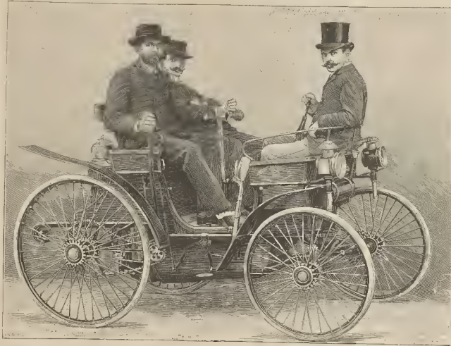
Fig. 1. Coche movido por el petróleo. Invención de los Sres. Peugeot; motor Daimler. (De una fotografía.)
